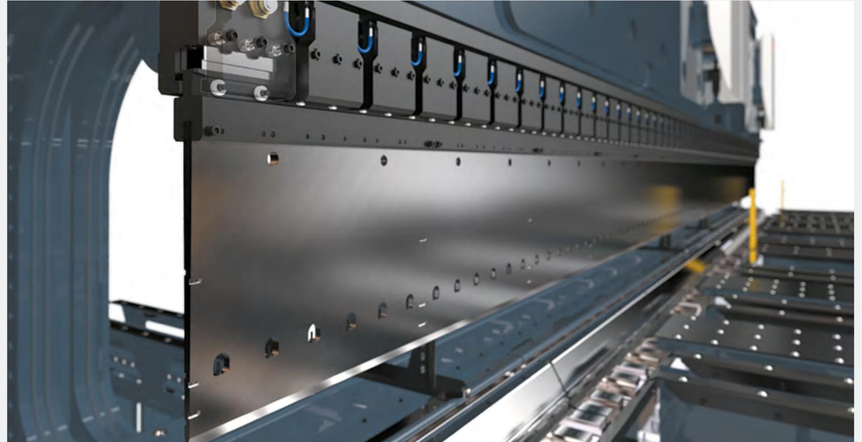
La technologie WILA STL est également proposée sur nos gammes, ce qui permet de localiser facilement les outils. Cette technologie intelligente utilise un éclairage LED pour guider visuellement les opérateurs et optimiser les activités de pliage.
