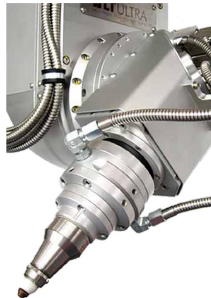
La protection anti-collision 3D éprouvée dont elle est équipée protège de manière fiable contre les dommages mécaniques.
