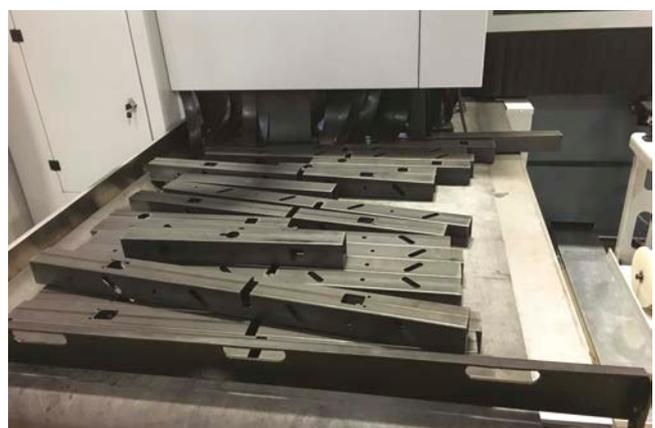
Les tubes jusqu'à 6 mètres de long sont automatiquement évacués par le convoyeur de déchargement.
