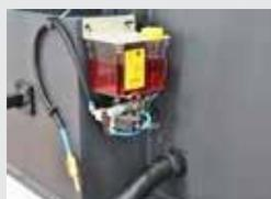
Tension hydraulique de la lame
