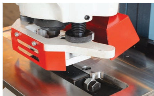
Poinçonnage et découpe de cornières
