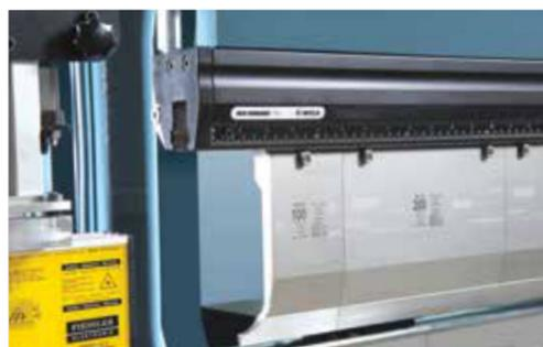
Porte-outils Wila à bridage mécanique ou hydraulique
