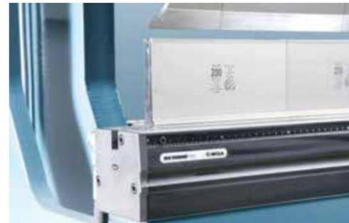
Table Wila à bridage mécanique ou hydraulique
