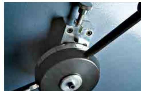
Soutien tôle arrière pour tôle fine
